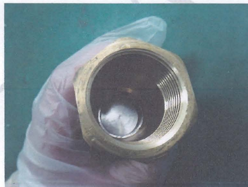
图 27 测试后 4# 无进水
