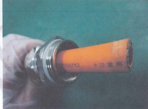
图 26 测试后 4# 无进水
