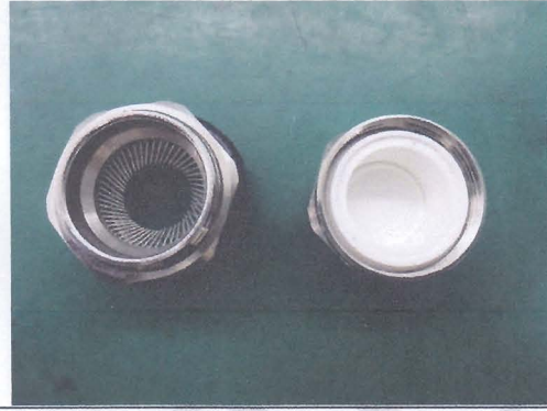
图 13 测试后 3# 无进水
