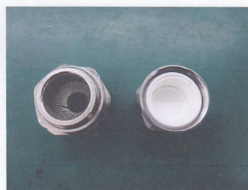
图 11 测试后 1# 无进水
