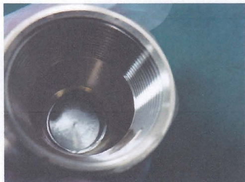
图 25 测试后 3# 无进水
