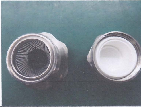
图 12 测试后 2# 无进水
