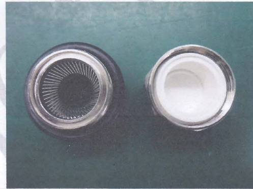
图 15 测试后 5# 无进水
