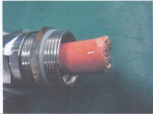
图 24 测试后 3# 无进水
