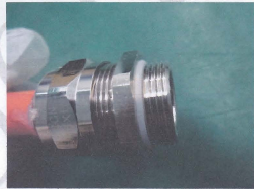
图 20 测试后 1`# 无进水
