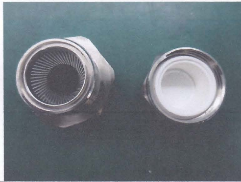
图 14 测试后 4# 无进水
